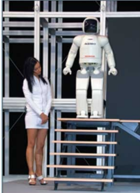
Рис. 8. Японская игрушка Asimo умеет ходить и бегать, подниматься по лестницам, распознавать речь, выполнять команды, произносить одну из сотни заученных фраз, носить грузы и толкать тележки (см. главу 11)
